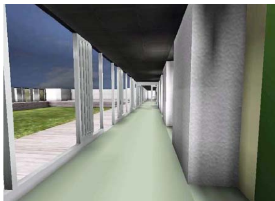
Visualisierung der Szene in Simulation. Das Modell beruht auf einer 3D-Geometriekarte, die aus 3D-Laserscans der Umgebung erzeugt wurde; die Flächen wurden manuell aus den Laserscan-Daten definiert und texturiert.
